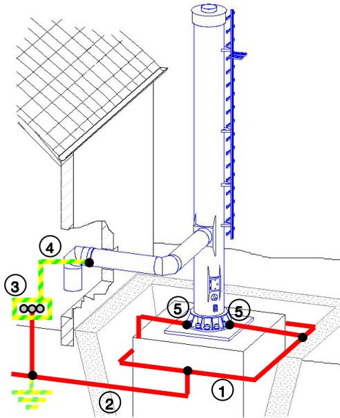
**Bild 1:** Freistehender Schornstein aus Metall mit Erdung
